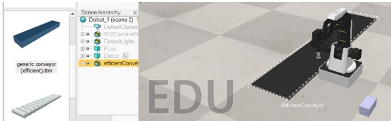
Abbildung 6 – Installation eines Förderers generic conveyor (efficient)
