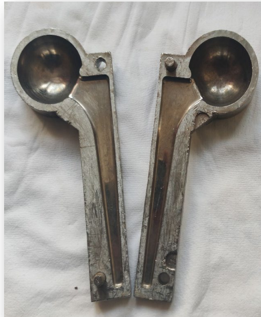
Рис. 3: Розбірна прес-форма після багаторазового використання для інтраопераційного виготовлення спейсера, розмір 50.
