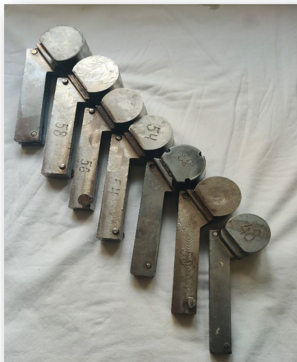
Рис. 3: Розбірна прес-форма після багаторазового використання для інтраопераційного виготовлення спейсера, розмір 50.
