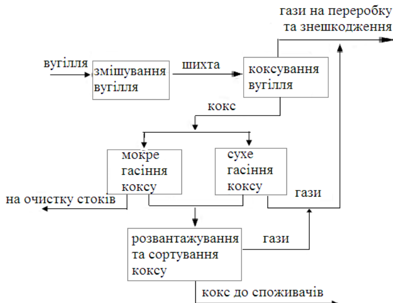
Рисунок 1 - Схема технологічного процесу виробництва коксу
