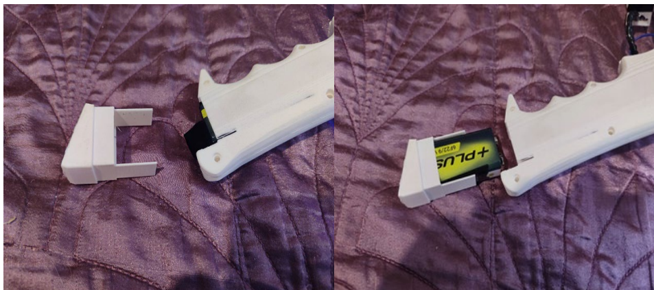
Рисунок 2. Заряджання приладу батареєю (авторська розробка).
