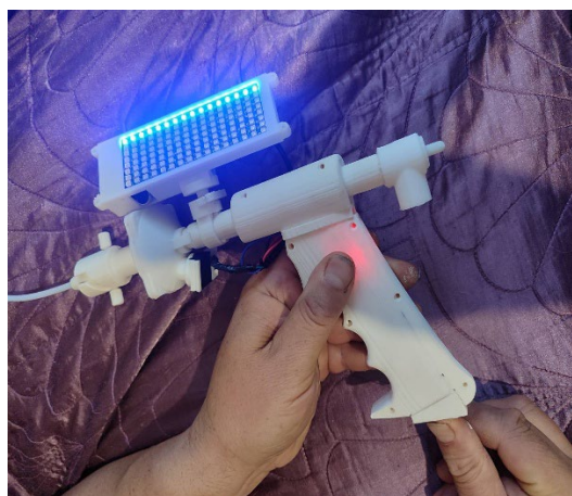
Рисунок 7. Інноваційний прилад для виявлення уламків у вогнепальній рані підготовлений для роботи (авторська розробка).
