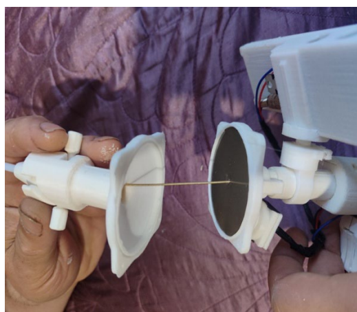
Рисунок 3. Процес відкриття камери фіксації звукової емісії (авторська розробка).
