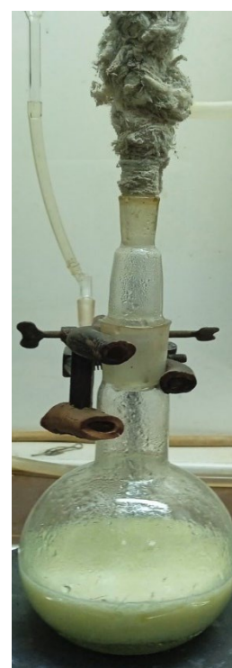
Рисунок 2 – Результати епоксидування натурального каучуку в кислому середовищі (а) та після відгону суміші вода-ксилол (б)
