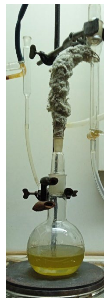
Рисунок 1 – Схема приладу(а) та лабораторна установка з насадкою Діна-Старка(б): 1 – холодильник; 2 – паропровід; 3 – збірник відгону; 4 – круглодонна колба; 5 – розчин епоксидованого натурального каучуку; 6 – електрична плитка
